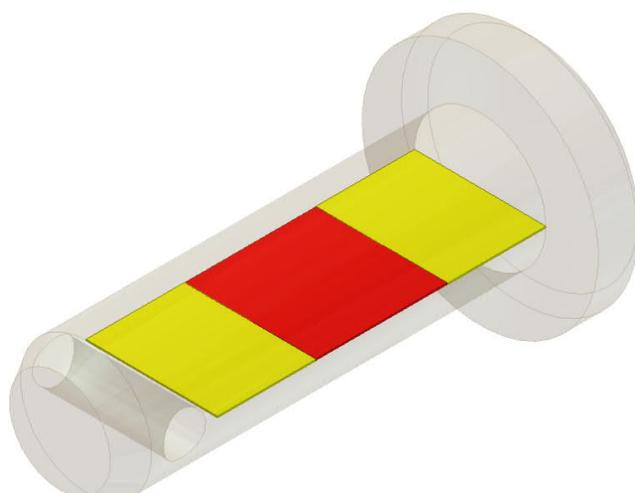
Die Darstellungen sollen verdeutlichen, welche Flächen unter Zug belastet sind. Bei der Flächenpressung wird mit den projizierten Flächen gerechnet.
