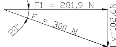
$F_y$  ist nicht gefragt, muss aber nebenher gelöst werden. Die Richtungen von  $F_x$  und  $F_y$  ergeben sich aus der Aufgabenstellung. Wenn nach der Gegenkraft gefragt wäre, wären  $F_x$  und  $F_y$  entgegengesetzt.
